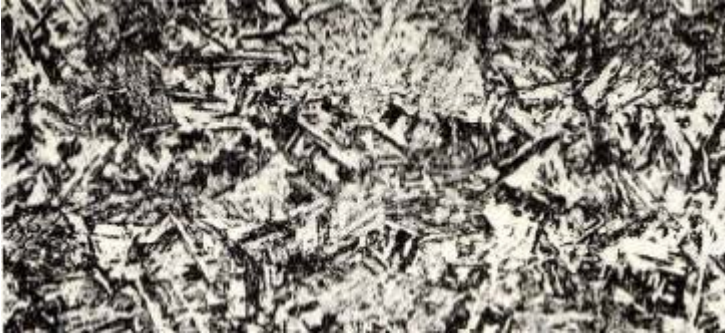
Burada 17-4PH kalite 1040 °C ‘de çözelti işlemine tabii tutulmuş, havada soğutulmuş ve 4 saat 495 °C ‘de yaşlanmaya bırakılıp havada soğutulmuş, menevişlenmiş martensitik yapı görülmektedir. (100x)
