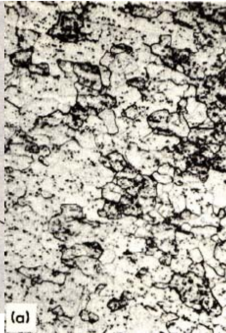
Burada %12 Krom içeren ferritik bir mikroyapı görülmektedir. Küçük karbür parçacıkları da mevcuttur. Malzeme tavllanmış bir malzemedir. (500x)
